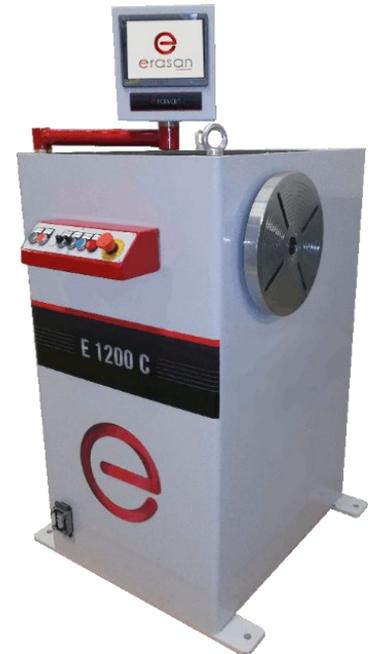
Die Maschine ist besonders für die Herstellung von Magnetspulen, Stromwandlern und Verteilertransformatoren bis 1200kVA geeignet. Es können quadratische oder flache Drähte aus Aluminium und Kupfer verarbeitet werden.
